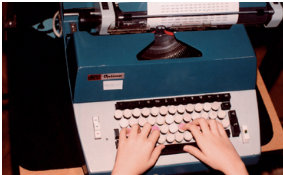
Az írógép billentyűi műanyag kupakkal vannak letakarva. Az alaptartás betűit piros kupak fedi. A kislány tíz ujjal vakon ír
